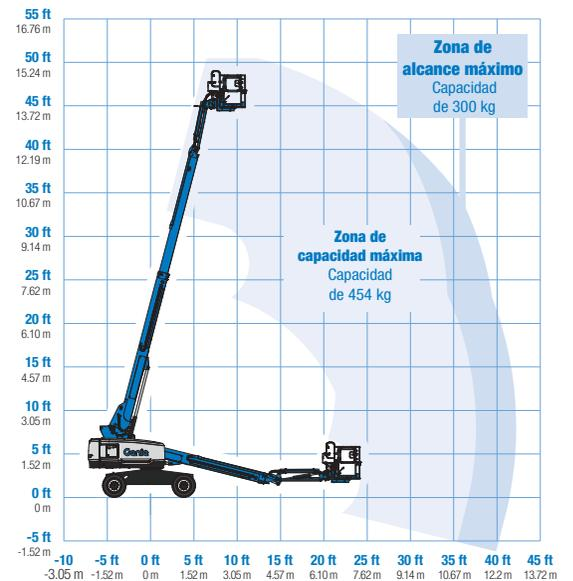
\*El equivalente en el sistema métrico de la altura de trabajo adiciona 2 m a la altura de la plataforma. El sistema usado en EUA agrega 6 pies a la altura de la plataforma.
